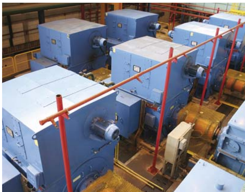
Motores Síncronicos SDL800, 3.000 kW, 3.100 V Aplicación: Laminadores (siderurgia)
