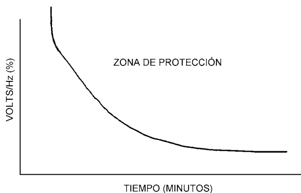
Figura 5B. Característica típica del relé de tiempo inverso
