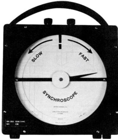
Figura 27. Sincronoscopio
